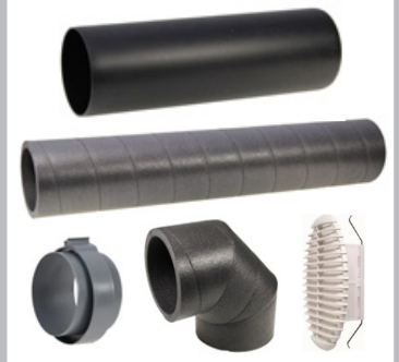
Basiskit luchtkanaal EPE DN160 Set bestaande uit: 4x Luchtkanaal recht, lengte 1000 mm 2x Luchtkanaalbocht 90° 4x Verbindingsmof luchtkanaal 2x Muurdoorvoering ABS kunststof, lengte 500 mm 2x Weerbestendig rooster, wit
