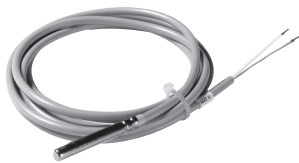
Elektronische boilervoeler voor boilerregeling via driewegklep zonder boilerthermostaat bv. in verbinding met BrainZ om boilertemperaturen en legionellabescherming te regelen. Nodig bij 'vreemde' boilers.
